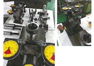
ゲージ名称：シャフトゲージ 対象ワーク：シャフト 測定項目：穴位置度
